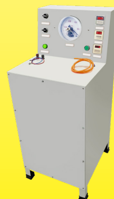
Kontrolle der Luftschalter-Betriebszyklen
